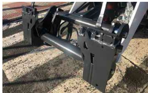
Quicktach / Bob-Tach adaptér (nutný pro veškeré příslušenství kromě lopat a paletizačních vidlí)
