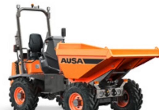
D301AHG 3000KG VYKLÁPĚNÍ OTOČNÁ KORBA VÝKON 18.5KW ŠÍŘKA 1,750MM PŘEVODOVKA HYDROSTATICKÁ
