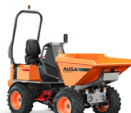
D151AEG 1500KG VYKLÁPĚNÍ OTOČNÁ KORBA VÝKON 19.6KW ŠÍŘKA 1,480MM PŘEVODOVKA ELEKTRICKÁ
