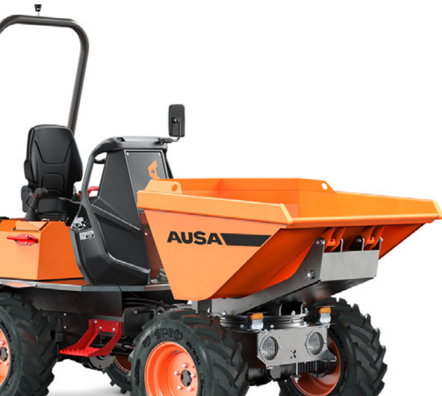
D151AHG 1.500KG VYKLÁPĚNÍ OTOČNÁ KORBA VÝKON 15.4KW ŠÍŘKA 1,480MM PŘEVODOVKA HYDROSTATICKÁ
