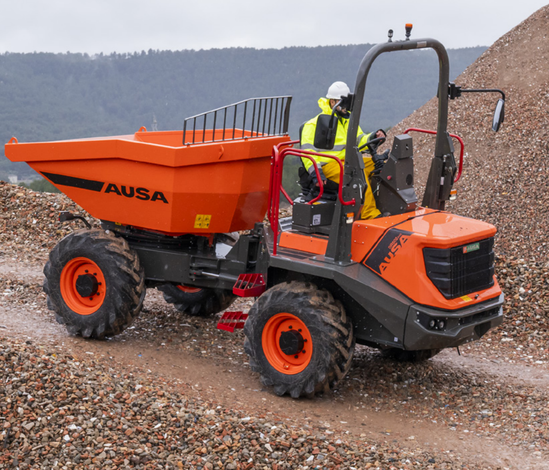
DR602AHG 6000KG VYKLÁPĚNÍ OTOČNÁ KORBA VÝKON 55.4KW ŠÍŘKA 2,210MM PŘEVODOVKA HYDROSTATICKÁ
