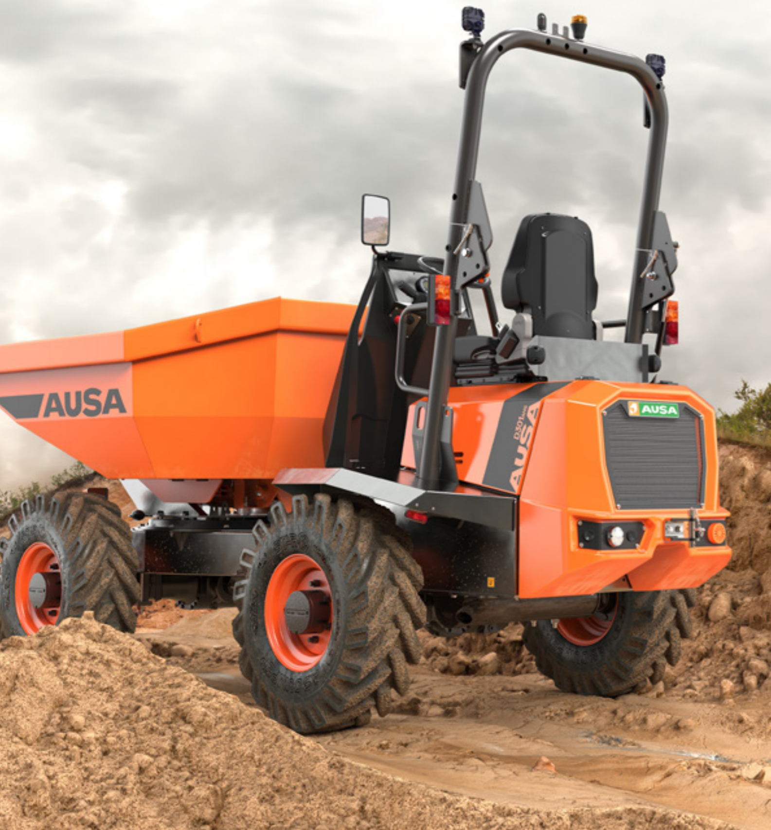
D201AHG 2000KG VYKLÁPĚNÍ OTOČNÁ KORBA VÝKON 18.5KW ŠÍŘKA 1,500MM PŘEVODOVKA HYDROSTATICKÁ
