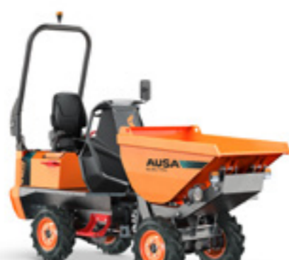
D101AEA COMPACT 1000KG VYKLÁPĚNÍ VYSOKÝ ZDVIH VÝKON 19.6KW ŠÍŘKA 1,000MM PŘEVODOVKA ELEKTRICKÁ
