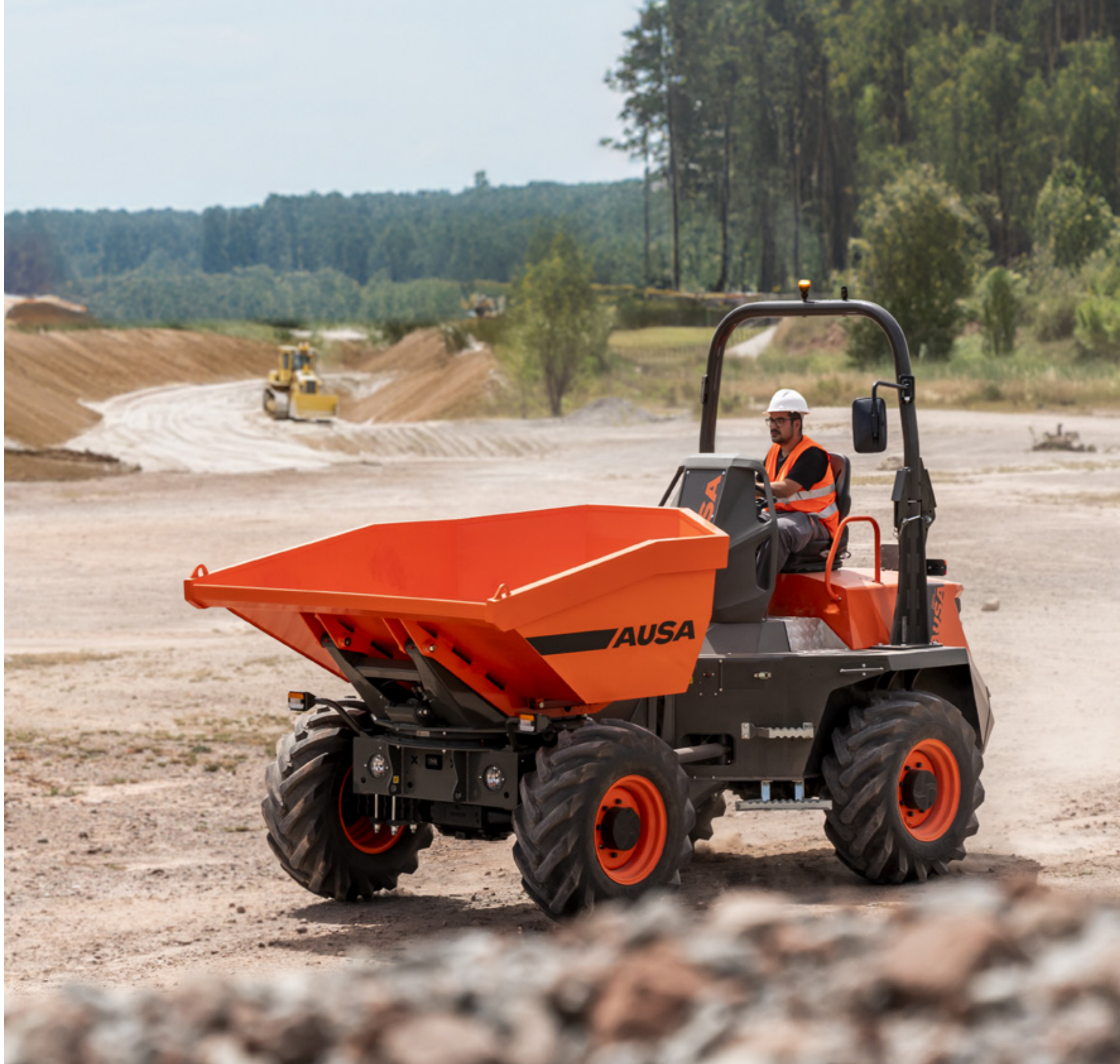
D1001APG 10000KG VYKLÁPĚNÍ OTOČNÁ KORBA VÝKON 55,4KW ŠÍŘKA 2,410MM PŘEVODOVKA HYDRODYNAMICKÝ MĚNIČ
