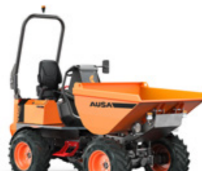
D151AHA 1500KG VYKLÁPĚNÍ VYSOKÝ ZDVIH VÝKON 15.4KW ŠÍŘKA 1,480MM PŘEVODOVKA HYDROSTATICKÁ
