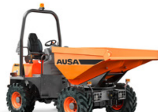
D350AHG 3500KG VYKLÁPĚNÍ OTOČNÁ KORBA VÝKON 32.8KW ŠÍŘKA 1,850MM PŘEVODOVKA HYDROSTATICKÁ
