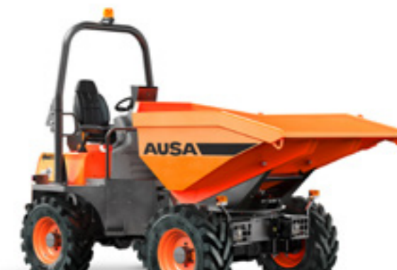
D450AHG 4500KG VYKLÁPĚNÍ OTOČNÁ KORBA VÝKON 32.8KW ŠÍŘKA 1,870MM PŘEVODOVKA HYDROSTATICKÁ
