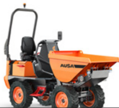
D101AHA 1000KG VYKLÁPĚNÍ HIGH TIP VÝKON 15.4KW ŠÍŘKA 1,090MM PŘEVODOVKA HYDROSTATICKÁ
